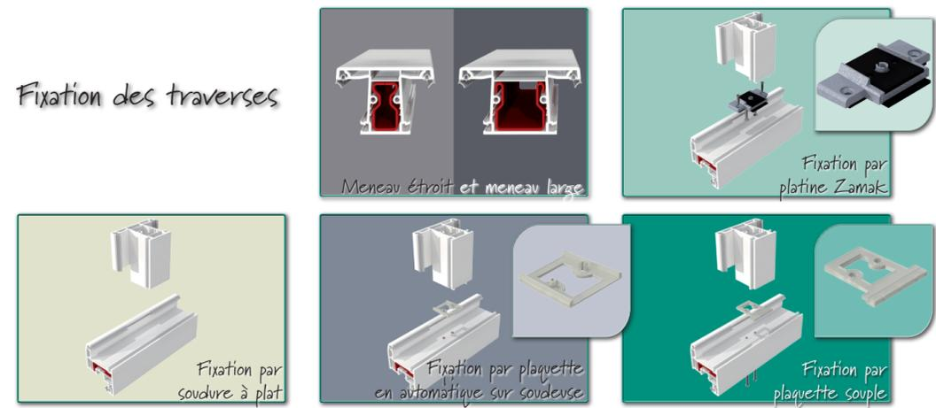
De la plus intégrée à la plus souple, découvrez des solutions de mise en oeuvre des traverses qui s'adaptent à vos contraintes industrielles.
