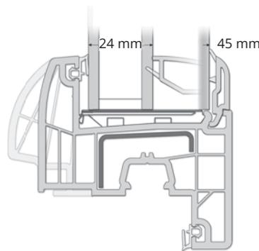
Capacité de remplissage jusqu'à 45 mm en ouvrant comme en dormant.
